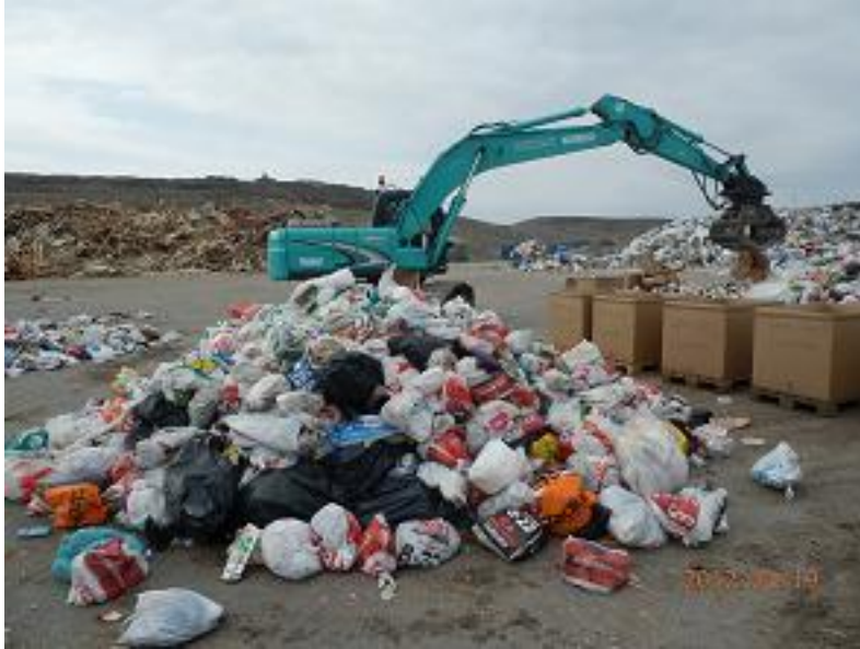
Blandning och provutttag med maskin med gripklo.
